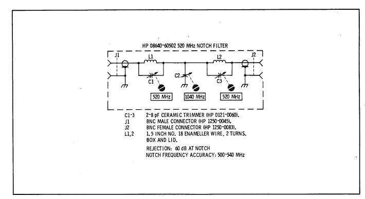
Figure 1-7. 520 MHz Notch Filter
